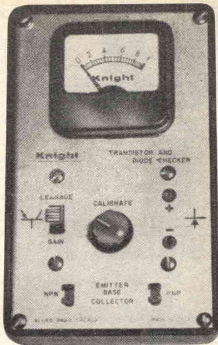
Aspetto esterno del prova transistori «Knight-Kit»: si noti la sistemazione dei comandi sul pannello in riferimento allo schema elettrico.
